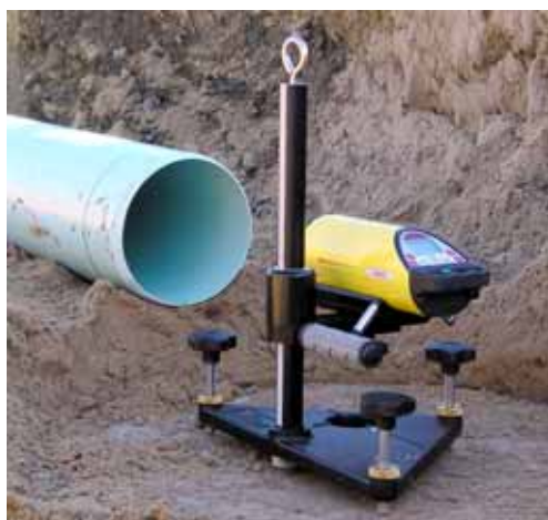
Justačná platňa slúži na jemné nastavenie základnej polohy a výšky
