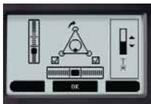
Jednoduchá elektronická libela a signalizácia stavu batérie
