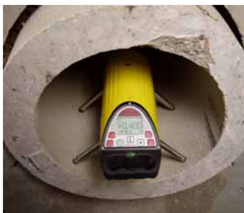
Vďaka veľmi malému priemeru sa dá PIPER nasadiť aj do tenkých rúr
