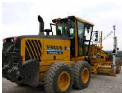
Grejder Váhostavu-SK riadený GPS na stavbe KIA
