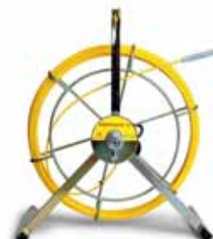
Digitrace™ s generátorovým módom určí polohu aj hĺbku nekovových vedení
