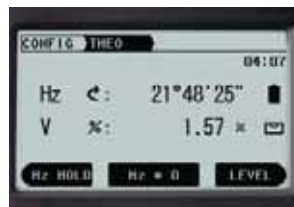
Prehľadné a presné odčítanie horizontálneho a vertikálneho uhla
