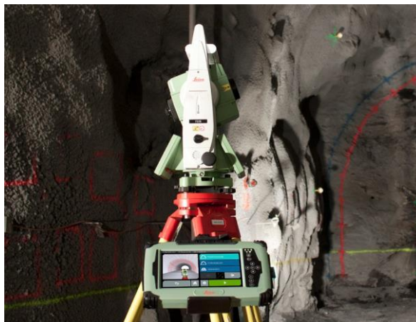
TMS Navigator: Ovládanie a kontrola celého projektu tunela pomocou jedného tabletu.
