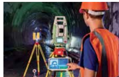
Amberg Navigator spolupracuje aj s laserovými skenermi a multistanicami Leica.
