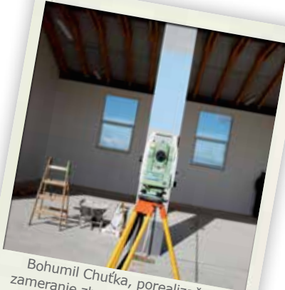
Ing. Nechuta st., meranie polohopisu a výškopisu s Leica Viva GS08plus a Leica TCR1202, Veľká Lomnica.
