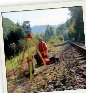
Ing. Minarech, Reming Consult a.s., zameranie železničnej trate s Leica MS60 a riešením SmartStation.
