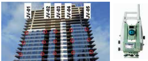
Obr. 4 Označenie referenčných bodov a Leica TS30
