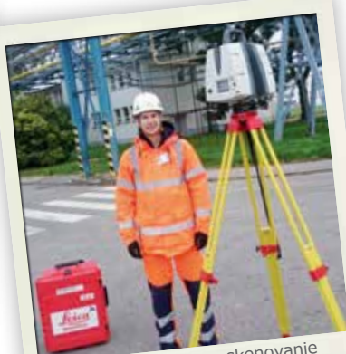
Geoaktual s.r.o., skenovanie potrubných mostov s Leica ScanStation P40 v závode DUSLO Šaľa.
