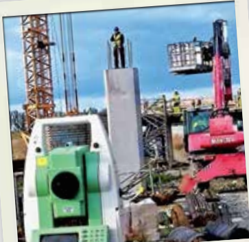
Ing. Fečík, Ing. Sokol, porealizačné zameranie piliera s Leica TCR1203 na moste 208, úsek Budimír - Bidovce diaľnice D1.
