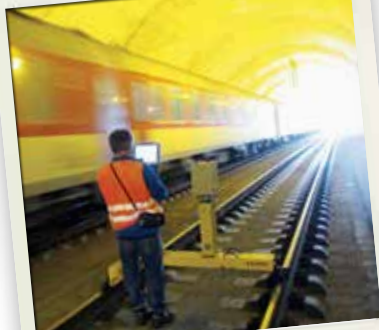
Ing. Salva, ŽSR a.s, skenovanie priestorovej prechodnosti systémom Amberg GRP 5000, tunel Turecký vrch.
