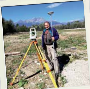
Ing. Nechuta st., meranie polohopisu a výškopisu s Leica Viva GS08plus a Leica TCR1202, Veľká Lomnica.
