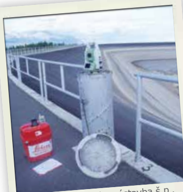
Vodohospodárska výstavba š.p., meranie AB plášťa s Leica TS30, VD Čierny Váh.
