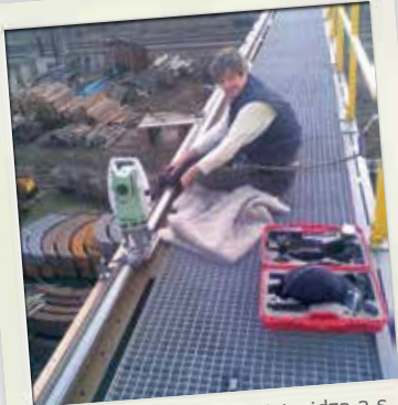
Hornonitrianske bane Prievidza a.s., zameranie žeriavovej dráhy s Leica TPS1200, Nováky.
