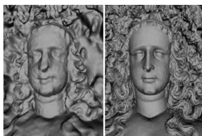
Obr. 2 3D model sochy z dát TLS a DF
