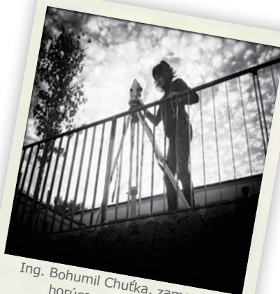
Hornonitrianske bane Prievidza a.s., zameranie žeriavovej dráhy s Leica TPS1200, Nováky.
