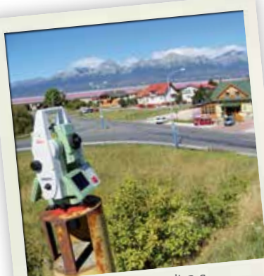
Reming Consult a.s., meranie železničnej trate s Leica TS15, Svit.
