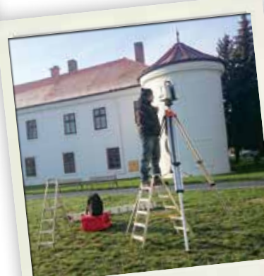
Geoaktúal s.r.o., skenovanie vodného kaštieľa s Leica ScanStation P40, Šaľa.
