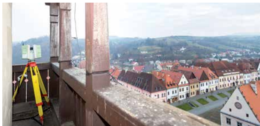
Obr. 3 Laserový skener ScanStation P20 a UAV systém Aibot X6 V2 počas zberu dát
