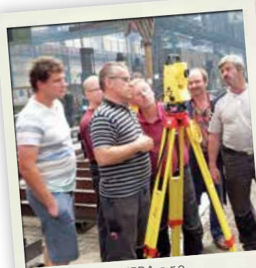
K-SUPRA s.r.o., meranie zváraných výrobkov s Leica Builder, Brezno.
