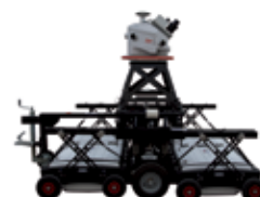
Pegasus:Stream na vyhľadanie podzemných vedení
