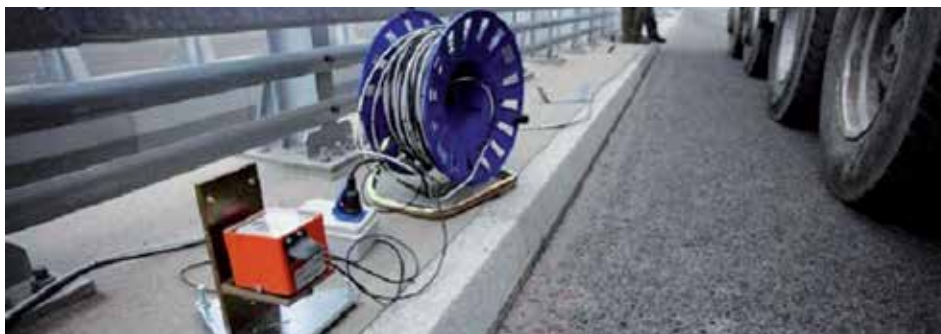
Umiestnenie náklonomerov v špeciálnych adaptéroch
