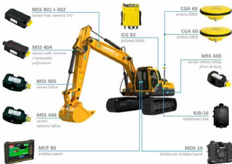
Ukážka 3D Dual GNSS systému pre rýpadlá
