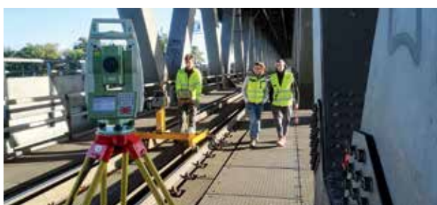
Predprojektové zameranie železničných koľají na Prístavnom moste v Bratislave so systémom Amberg GRP FX a Leica Viva TS15.
