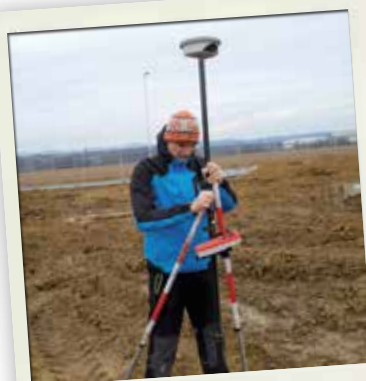
Ing. Ondriáš, GEPRON s.r.o., zameranie kubatúr s Leica GPS900, Levice
