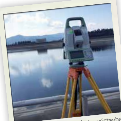
Ing. Prvý, Vodohospodárska výstavba a.s., etapové meranie s Leica MS60 na VS Čierny Váh.
