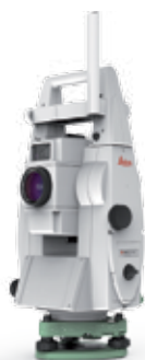
Rozšírený model Leica TS13 s rádiom pre jednomužné meranie
