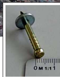
Obr. 4 Detail okolí měřeného bodu a rozměr nastřelovacího hřebíku
