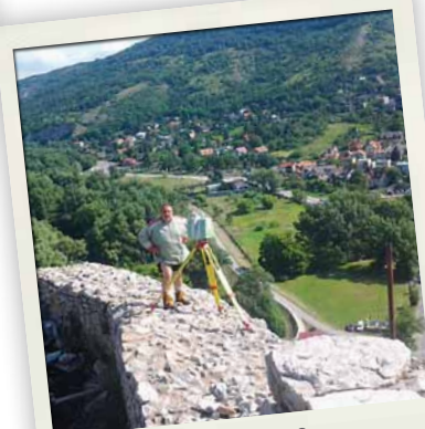
3D-SCV s.r.o., ScanStation P20 pri skenovaní hradu Devín
