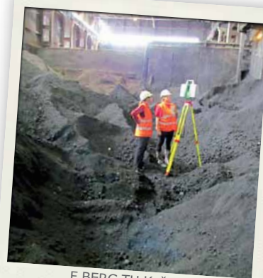
F BERG TU Košice, ScanStation C10 pri určovaní objemov hald v cementárni
