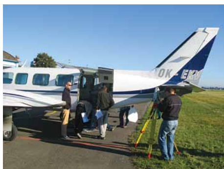
Obr. 5 Meranie odsadenia GNSS antény lietadla od stredu skenera s totálnou stanicou LEICA TS 15
