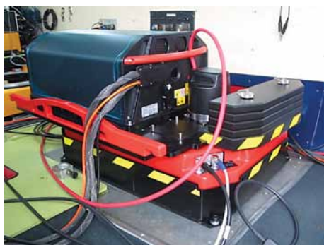
Obr. 4 Letecký laserový skener LEICA ALS 70 CM a strednoformátová multispektrálna digitálna kamera LEICA RCD 30
