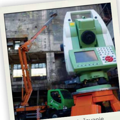
SYKO s.r.o., vytyčovanie podporných bodov žerňavovej dráhy
