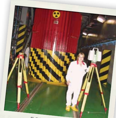
F BERG TU Košice, ScanStation C10 pri skenovaní kontajnera pre jadrový odpad
