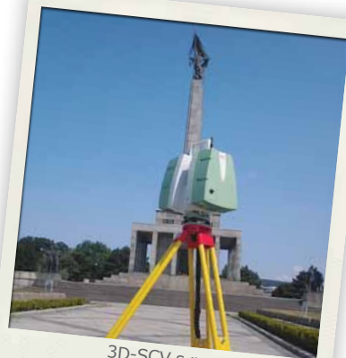
3D-SCV s.r.o, ScanStation P20 pri skenovaní pamätníku Slávin
