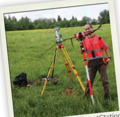
Reming Consult a.s., SmartStation pri meraní geologických profilov pre nový železničný tunel Čadca
