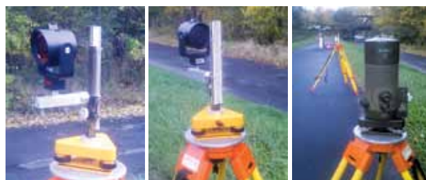
Obr. 5 Odrazový hranol na vertikálnej posuvnej podložke (vľavo a v strede) a konfigurácia prístroja, hranola a nivelačného prístroja (vpravo)
