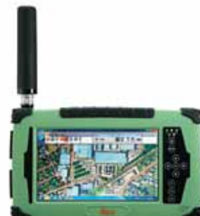
CS25 GNSS 50cm DGPS / 10cm RTK
