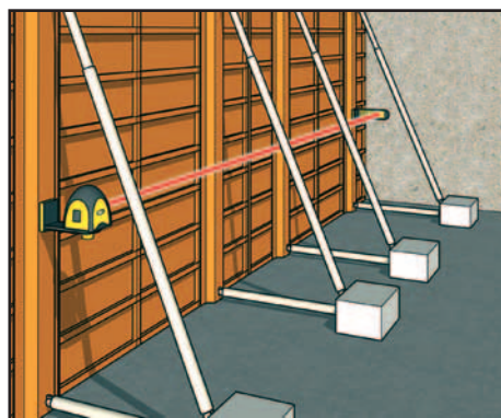
Zaměření roviny betonářského bednění
